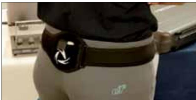
Figura 2. Posizionamento del sensore inerziale G-Sensor
